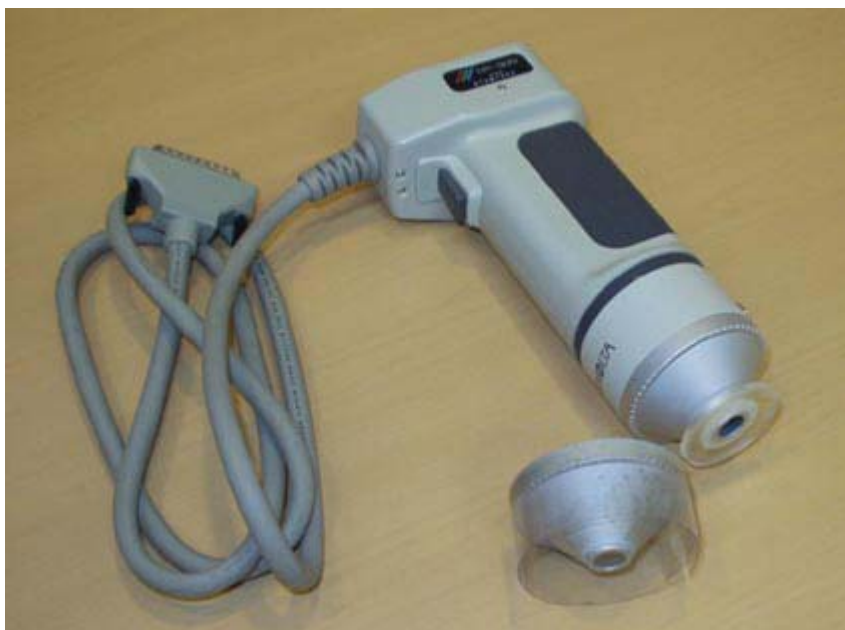
写真1 色彩色差計(ミノルタ製CR-300)とアダプター
